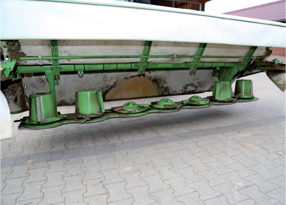
De frontmaaier heeft zeven maaischijven. De buitenste drie aan weerszijden draaien naar binnen, de middelste naar buiten. Dankzij de binnenste trommels krijg je, zonder extra zwadschijven, een smal zwad dat ook bij zware snedes tussen de trekkerwielen past.
