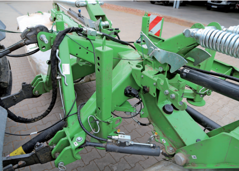
De aanbouwboek van de achtermaaier is eenvoudig, maar voldoet prima. Qua hydrauliek heb je standaard drie enkelwerkende ventielen nodig voor in-/uitklappen, en het uitheffen en laten zakken op kopakkers.
