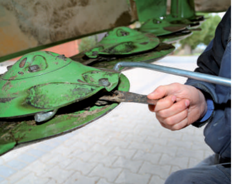
Messensnelwissel is standaard, met slijtvaste mesbouten en een zeer goede, slipvaste snelwisselsleutel.
