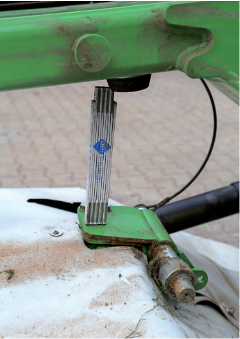
Als er een duimstok tussen de draagarm en de rubberen stop van de achtermaaier past, heb je de juiste hoogte.
